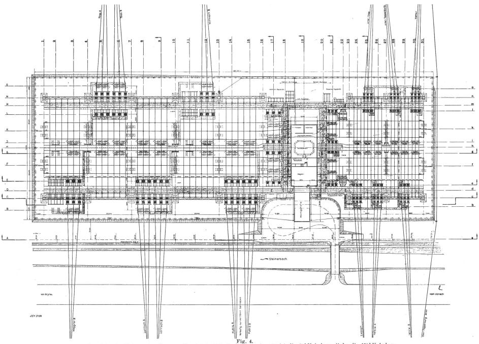
Grundriss des Unterwerkes Grynau. Masstab 1:1000. Rechts von Axe 19 ist die 50kV-Aulage, links die 150kV-Anlage.
