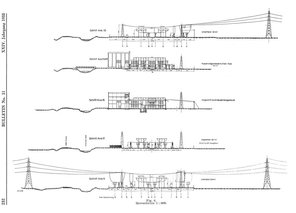
gen zu unterdrücken. Die Berechnungen ergaben beim gewählten Seilquerschnitt von 185 mm<sup>2</sup> als kritische Glimmspannung ca. 132 kV.
