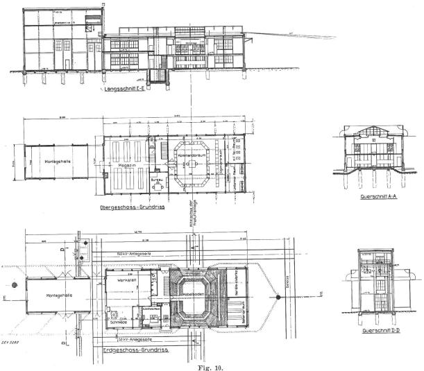
Längsschnitt, Grundrisse und Querschnitte des Betriebsgebäudes. Masstab 1:600.
