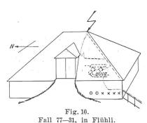
Einschlagstelle: Firstecke des Schindeldaches ohne äussere Metallteile. Die Entladung nahm ihren Weg längs der Dachfläche, wo viele Schindeln beschädigt wurden, drang durch das Dach in das Innere auf alte Eisenröhren, sprang auf den Schrägbalken über, dem ein starker Splitter abgerissen wurde, streifte die eisernen Beschläge von Wagen und Schlitten (verrusste Stellen), drang durch das Futterloch in den Stallraum ein, um durch die Wand (Beschädigung) hindurch im Sta-
