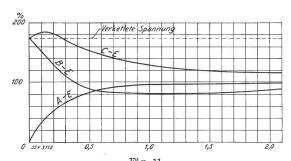
Fig. 11. Darstellung des Spannungsverlaufes zwischen den drei Leitern und der Erde bei einem einpoligen Erdschluss über einen Ohmschen Widerstand in nicht geerdeten Drehstromnetzen.
