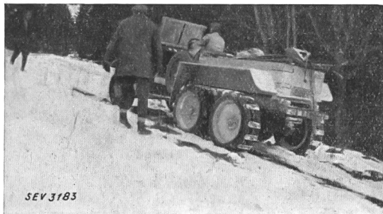
Fig. 18. Der Lastwagen fährt mit aufmontierten Raupen über eine verschneite Alpweide.
