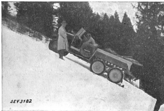
Fig. 17. Der Lastwagen fährt mit aufmontierten Raupen über eine verschneite Alpweide.
