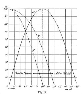
Abhängigkeit der synchronisierenden Leistung und der Wirkleistung vom Stabilitätswinkel  $\vartheta$  der Uebertragung.
