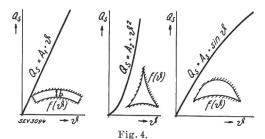
Verschiedene Lichtschlitzquerschnitte Qs in Funktion von  $\vartheta$ .
