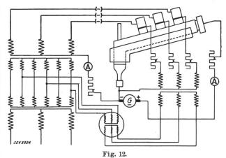
Schaltschema der dreianodigen Steuerröhre für Phasenkompensation.
