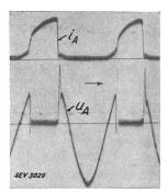
Fig. 16. Fig. 15. 1 mm ~ 23,7 V ~ 9,6 A. 1 mm ~ 21,1 V ~ 8,6 A. Oszillogramme der Unterbrechung eines Einphasenanodenstromes mit Kommutierungsgitter.  $i_{\mathsf{A}}$  Anodenstrom. Anodenspannung.
