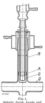
Schnitt durch Anode und Gitter des Steuereinsatzes.
