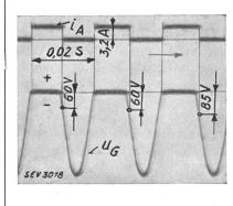
Fig. 4. Oszillogramm der Unterbrechung eines Anodengleichstromes mittels 50periodiger Gitterwechselspannung. Anodenstrom; 1 mm ~ 1,02 A. Gitterspannung;  $u_{\mathsf{G}}$  $1 \text{ mm} \sim 16,2$   $t_{\text{Hg}} 46^{\circ} \text{ C.}$  $p_{\rm Hg}$   $10 \cdot 10^{-3} \rm mmHg$ .
