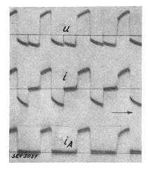
Fig. 17. Selbständige Wechselrichtung mittels Löschsteuerung und Kommutierungsgitter.
