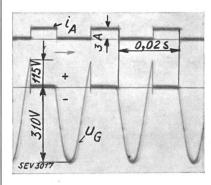
Fig. 3. Oszillogramm der Unterbrechung eines Anodengleichstromes mittels 50periodiger Gitterwechsel-spannung. Anodenstrom; 1 mm ~ 1,02 A. Gitterspannung; 1 mm  $\sim$  16,2 V,  $t_{Hg}$  25 ° C. p<sub>Hg</sub> 2 · 10-3 mmHg.
