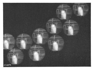
Zeitlupenaufnahmen eines Lichtbogens in Wasserschalter mit Wasserkathode.
