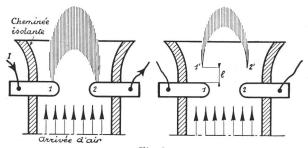
Fig. 8. Schematische Darstellung der Blaswirkung im Luftschalter.
