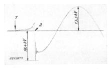
Fig. 7. Kathodenstrahloszillogramm des Spannungs-Verlaufs im Augenblick der Stromunterbrechung.
