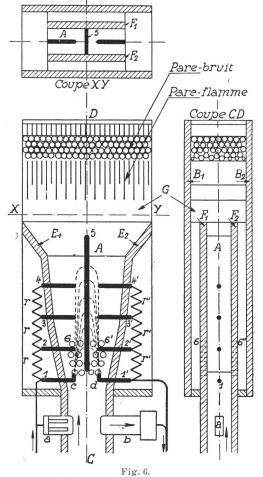
Schematische Darstellung des elektrischen Teils eines Druckluftschalters.
