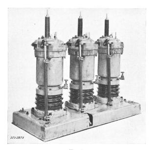
Fig. 3. Ansicht eines Translationsschalters für 25 kV Nennspannung, 500 A Normalstrom und 500 MVA Abschaltleistung.
