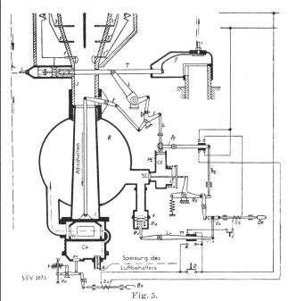
Schematische Darstellung des mechanischen Teils eines Druckluftschalters.
