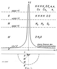
Temperaturverlauf im Wasserdampflichtbogen.
