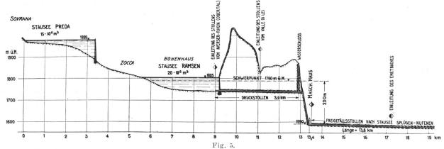
Projekt für die Ausnutzung der Hinterrhein-Wasserkräfte. Zuleitung des Averser Rheines. Maßstab: Horizontal 1:375000; Vertikal 1:37500.
