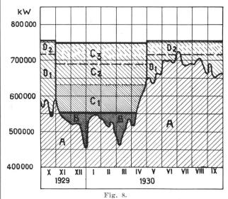
Projekt für die Ausnutzung der Hinterrhein-Wasserkräfte. Der Ausgleich des schweizerischen hydroelektrischen Ener-giediagramms 1929/30 durch die Hinterrhein-Kraftwerke.
