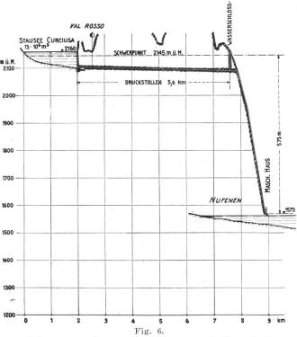
Projekt für die Ausnutzung der Hinterrhein-Wasserkräfte. Nebenkraftwerk Curciusa—Nufenen. Maßstab: Horizontal 1:375 000; Vertikal 1:37 500.
