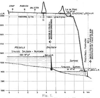
Projekt für die Ausnutzung der Hinterrhein-Wasserkräfte. Nebenkraftwerk Lai da Vons-Sufers. Maßstab: Horizontal 1:375000; Vertikal 1:37500.
