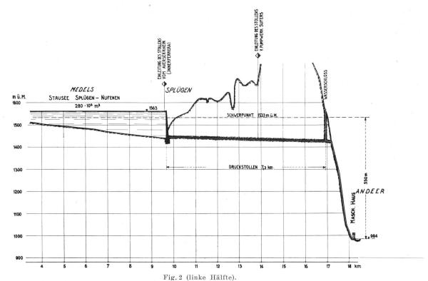
Projekt für die Ausnutzung der Hinterrhein-Wasserkräfte. Gefällstufe Splügen-Andeer. Maßstab: Horizontal 1:375 000; Vertikal 1:37 500.
