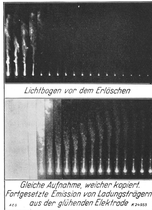
Fig. 6. Unterbrechungsvorgang im Druckgasschalter.
