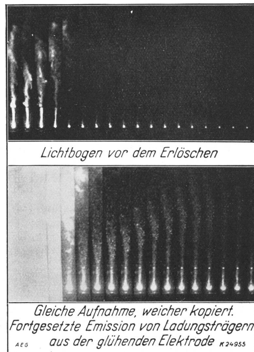
Fig. 6. Unterbrechungsvorgang im Druckgasschalter.
