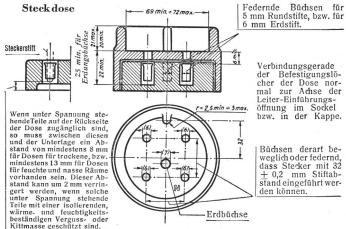
Verbindungsgerade der Befestigungslöcher der Dose normal zur Achse der Leiter-Einführungsöffnung im Sockel bzw. in der Kappe.
