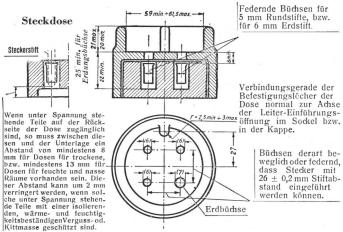
Ausser dieser Norm sind die Steckkontakt-Normalien des SEV massgebend. Die eingeklammerten Masse unterstehen in bezug auf das Qualitätszichen nicht der Prüfung durch den SEV.
