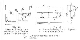
wiedergegeben und bedarf keiner weiteren Erläuterung. Eine ähnliche Kompensationsmethode von Agnew ist in Fig. 43 dargestellt; sie hat den Vorteil, dass die Fehlergrössen in einfacherer Weise aus der Schaltung hervorgehen. Stromlosigkeit im Vibrationsgalvanometer (VG) wird durch passende Einstellung der Widerstände R' und R" und der gegenseitigen Induktion M erzielt. Uebersetzungsfehler und Fehlwinkel sind aus Fig. 43 b gegeben durch:
