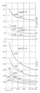
Fig. 5. Fehlerkurven eines 200/5-A-Wandlers bei cos=1. Oben Uebersetzungsfehler in  $v_0^i$  ( $\Delta i v_0^i$ , resp.  $\Delta \Delta i v_0^i / VA$ ), unten Winkelfehler in Minuten Voreilung ( $\theta^i$  resp.  $\Delta \theta^i / VA$ ), in Funktion des Sekundärstromes (A). Kernmaterial: Legiertes Eisen. D=38 cm, H=18 cm.
