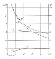
Fig. 37. Fehlerkurven ( $\triangle \ddot{u}^{0}/_{0}$  und  $\theta$ ') des 400/5-A-Wandlers. D = 41 cm, H = 18 cm.Gewicht = 120 kg. Bürde = 0 bis 50 VA für  $\cos \varphi$  im Bereich von Fig. 39a. Gewöhnlicher Wandler.
