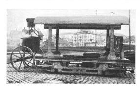
Fig. 1. Elektrischer Asphaltkochwagen der Städtischen Strassenbahn Zürich.
