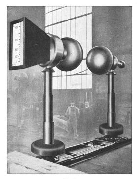
Fig. 9. Statisches Voltmeter von Trüb, Täuber & Cie. für 1 Million Volt.
