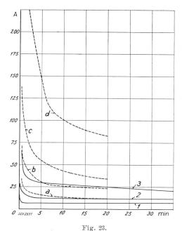
Strom-Zeit-Kurven von Installationsselbstschaltern (1 bis 3) und Strom-Zeit-Kurven von Leitern entsprechender Nennstrom-stärken (a bis d).
