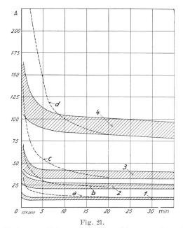
Streubänder von Sicherungen mit geschlossenem Schmelzeinsatz und Stromzeitkurven von Leitern entsprechender Nennstromstärken.
