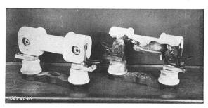
Fig. 19. Zu den Versuchen Fig. 14, 16 und 17 benützte Sicherungen.
