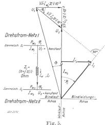
Schema und Vektordiagramm der verlustlosen Kuppelleitung zweier gleichfrequenter Drehstrom-Netze mit verschiedenen Spannungen.
