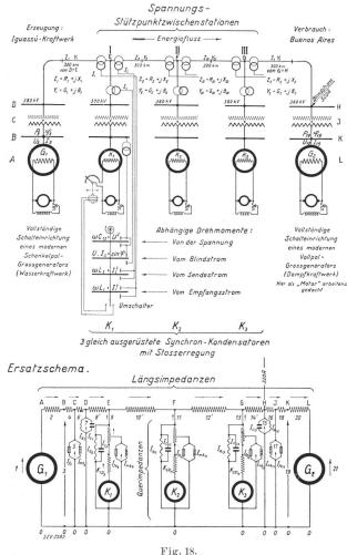
Generelles- und Ersatzschema einer geplanten Grossleistungsübertragung von 300 MW über 1200 km bei 380 km vom projektierten Ignassú-Kraftwerk nach Buenos-Aires (Argentinien), welche mit drei Stabilitäts-Zwischen-Kondensatoren ausgerüstet wurde.
