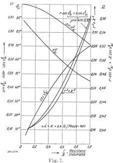
Hilfskurven für rasche Berechnung der Kippleistung  $P_{ki}$  als Funktion von  $\frac{r}{x}$
