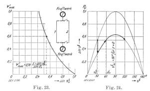
Induktanz-Vergrösserung durch Ausfallen einer Leitung eines Parallelstranges und der sie begleitende Schwingungsvorgang.
