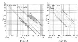
Zwei Kurvenscharen für 66 kV und 110 kV (Fig. 12);
