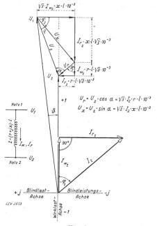
Fig. 6. Schema und Vektordiagramm einer wirklichen Kuppelleitung zweier gleichfrequenter Dreh-strom-Netze mit verschiedenen Spannungen am Anfang und Ende.
