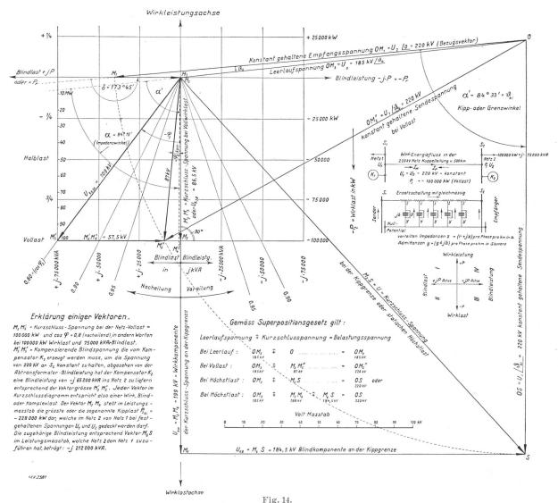
Betriebsdiagramm einer 100-MW-220-kV-500-km-Netz-Kuppelleitung, worin sämtliche Konstanten berücksichtigt sind. Es zeigt auch die Kipplast, mit welcher die Leitung beansprucht werden kann.
