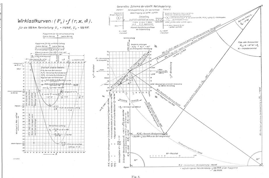
Lastkurve, Schema und Kipplastbetriebsdiagramm einer 100-km-Drehstrom-Kuppel-Freileitung, mit den festen Spannungen  $U_1 = 110$  kV;  $U_2 = 100$  kV.
