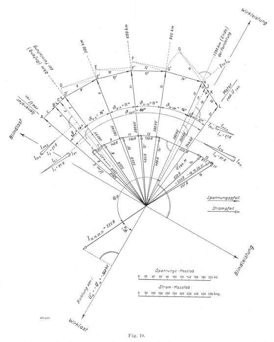
Stabilitätsdiagramm für die Grossleistungsübertragung von 300 MW über 1200 km bei 380 kV (nach Fig. 18). Der Belastungsstrom von 535 A ist absichtlich unkompensiert als Wirk-Blindlaststrom dargestellt. G2 würde selbstverständlich den Kompensations-Strom liefern. Die künstliche Blindstromzufuhr bei H im Schema von 320 A kann so unterbleiben.
