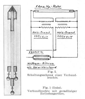
Zwei abgestimmte gerade Wolframröhren je 75 cm lang und 30 mm Durchmesser in matter oder weiss lackierter Ausführung mit normalem Edisonsockel, einer Brennspannung von 150 V, einer Leistung von 70 W und einem Lichtstrom von etwa 500 Lumen.
