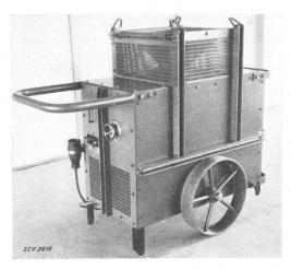
Fig. 1. Philips-Schweissgleichrichter, neueste Konstruk-tion, 22 V, 180 Å, Gleichstromleistung, mit um-schaltbarer Drosselspule.
