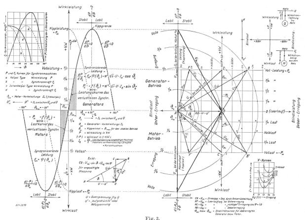
Stabilitätsdiagramm und Leistungskurven einer verlustlosen und ungesättigten Vollpol-Synchronmaschine beim Motor- und Generatorbetrieb. (Anstatt FsG und FsM lies: PsG und PsM).
