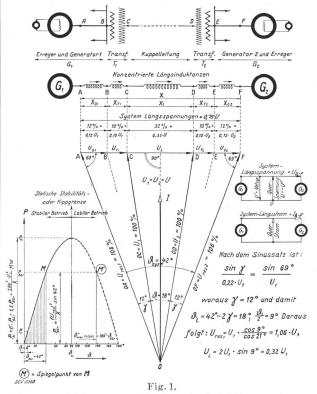
Schema und Diagramm für ein rein induktives und querstromloses-, also verlustloses Energie-Ueberlastungs-System, für noch 50 % statisch steigerbare Last. (Es ist sin  $42^{\circ} = \frac{100}{100 + 50} = 0,67.$ )
