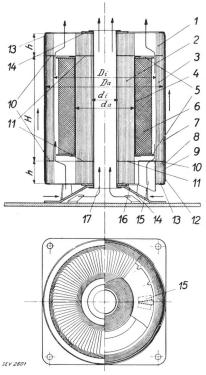
Fig. 5. Schnitte durch den Evolventen-Transformator. Erklärung der Zahlen im Text.
