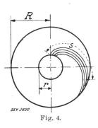
Blechdicke bestimmt ist. Dieser nicht ausgenutzte Teil des Spulenhohlraumes ist aber sehr klein im Verhältnis zu den freibleibenden Teilen bei Verwendung ebener Bleche nach Fig. 1 bis 3. Bezeichnet man den Halbmesser des Kernquerschnittes (Fig.4) aussen und innen mit R und r, die Blechzahl mit n, die Blechdicke
