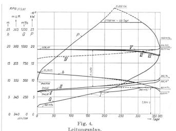
Totale Abflussmenge des Rheins (Dauerkurve Mittel 1906 bis 1925, gemessen am Pegel Nol). Ausgenützte Wassermenge. Wasserspiegel des Rheins beim Auslauf des Unterwasserstellens
