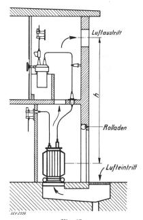
Fig. 17. Zweckmässig gelüftete Transformatorenstation.
