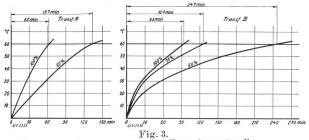
Transformator BZulässige Dauer der Ueberlasten von 50%, 75% und 100%, ausgehend vom kalten Zustand, nach Massgabe der Oelerwärmung.
