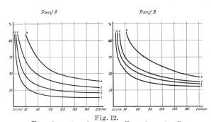
Transformator A Transformator BZulässige Dauer (min) der Ueberlasten (%) bis zur Grenz-erwärmung der Wicklung von 70° C.
