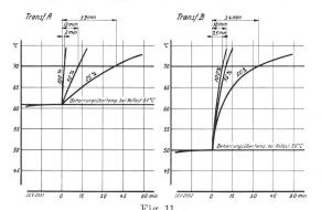
$\begin{array}{c} {\rm Fig.\,11.} \\ {\rm Transformator}\,A & {\rm Transformator}\,B \\ {\rm Zul\"{assige}}\,{\rm Dauer}\,{\rm der}\,{\rm Ueberlasten}\,{\rm von}\,\,25\,\%,\,50\,\%,\,75\,\%\,{\rm und}\,\,100\,\%,\\ {\rm ausgehend}\,\,{\rm von}\,\,{\rm der}\,\,{\rm Beharrungs\"{u}bertemperatur}\,\,{\rm bei}\,\,{\rm Vollast},\\ {\rm nach}\,\,{\rm Massgabe}\,\,{\rm der}\,\,{\rm Wicklungserw\"{armung}}. \end{array}$
