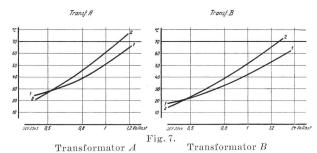
Transformator AStationäre Wicklungs- und Oelübertemperaturen (° C) in Funktion der Belastung.
