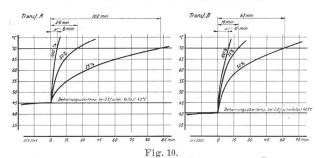
Transformator BTransformator A Zulässige Dauer der Ueberlasten von 25 %, 50 %, 75 % und ausgehend von der Beharrungsübertemperatur bei 0,8 Vollast, nach Massgabe der Wicklungserwärmung. 5 % und 100 %, bei 0,8 facher
