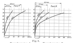
Transformator A Transformator B Zulässige Dauer der Ueberlasten von 50 %, 75 % und 100 %, ausgehend vom kalten Zustand, nach Massgabe der Wicklungserwärmung.
