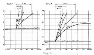
Transformator BTransformator AZulässige Dauer der Ueberlasten von 25 %, 50 %, 75 % und 100 %, ausgehend von der Beharrungstemperatur bei Vollast, nach Massgabe der Oelerwärmung.
