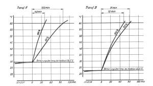
Fig. 4. Transformator ATransformator BZulässige Dauer der Ueberlasten von 50 %, 75 % und 100 %, ausgehend von der Beharrungstemperatur bei Halblast, nach Massgabe der Oelerwärmung.
