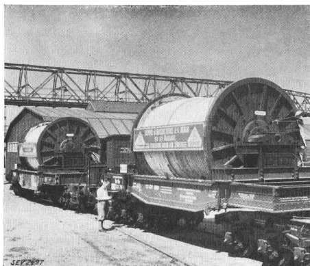
Fig. 4. 60-t-Spezialeisenbahnwagen für Kabeltransport.
