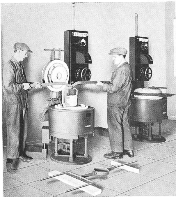
Fig. 19. Elektrische Einsatz-Glüh- und Schmelzöfen der Maschinenfabrik Oerlikon.
