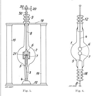
nen Stromdurchführung 3, 4 angebracht. Der bewegliche Kontaktteil 6 mit dem Führungsteil ist durch die Kontaktstange 8 mit dem elastischen Metallstiefel 9 verbunden, der in das Glasgefäss eingeschmolzen ist. Der Glaskolben 2 ist zwischen den Traversen 12 und 19 auf den Isolatoren 15 und 16 gelagert. Die Betätigung des Schalters erfolgt durch den Hebel 20, der zwischen den beiden Anschlagstücken 30 des beweglichen Kontakts verschiebbar ist.
