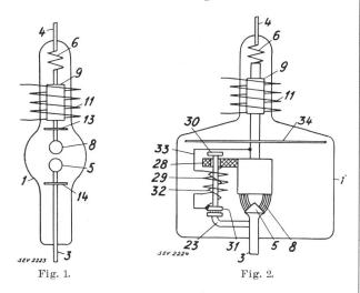
In Fig. 1 und 2 sind schematisch zwei Ausführungsformen von Vakuum-Hochleistungsschaltern dargestellt, die von der Metropolitan Vickers Electrical Co. Ltd., Westminster, im Jahre 1923 gebaut wurden. Schalter und Schaltkontakte sind in einem Glaskolben eingeschlossen, der ein Vakuum von weniger als 10<sup>-5</sup> mm Hg aufweist. Die Stromzu-
