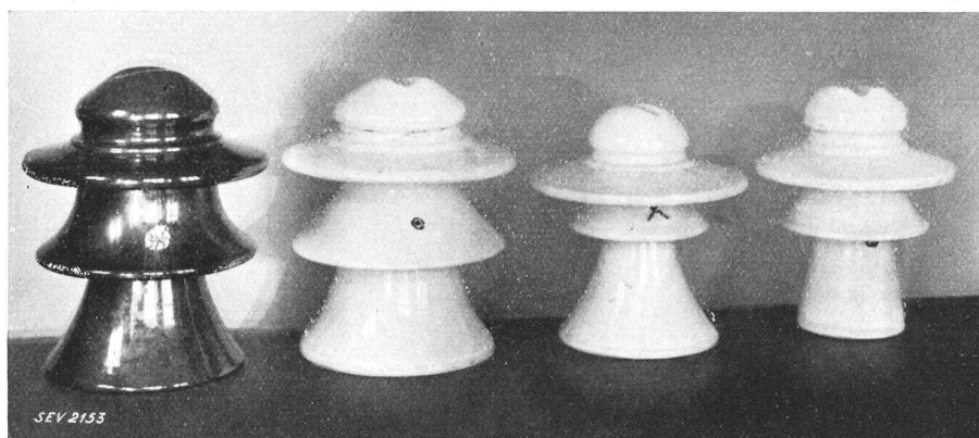
a b c d Fig. 10. Isolateurs rigides de 50 kV percés au cours des essais de choc électrique.
