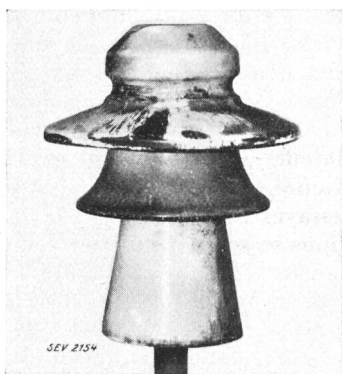
Fig. 11. Isolateur rigide de 50 kV tension nominale (Nos. 5, 6 et 7).
