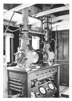
Fig. 1. Oscillographe cathodique double.
