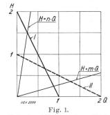
Unterdruckkurven eines Hochund eines Niedrigvakuumstaubsaugers.
