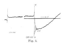
Oscillogramme cathodique de la tension après l'extinction de l'arc de rupture dans un interrupteur à eau. a = pointe de la tension à l'instant de l'extinction de l'arc, b = pointe de la tension due à l'oscillation transitoire,  $f_0 = 7000$  p/s (station d'essais à grande puissance BBC).
