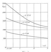
Fig. 8. Vitesses de rétablissement des tensions de rupture de la station d'essais à grande puissance de la S.A. Brown, Boveri, en fonction du nombre de bobines de réactance l insérées dans le
