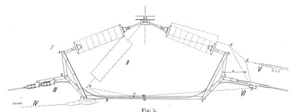
150-kV-Halbabspannung mit Trapez. Maßstab ca. 1:40.
