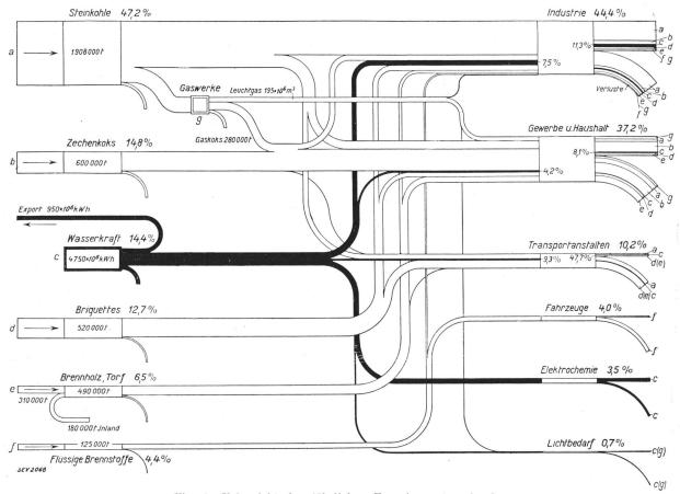
Fig. 1. Uebersicht des jährlichen Energieumsatzes in der Schweiz, umgerechnet in keal als einheitliches Vergleichsmass (angenäherte Werte).
