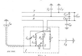
Fig. 4. Schema der Messbrücke.
