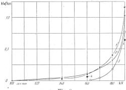
Fig. 8 Koronaverluste in kW/km in Funktion der verketteten Spannung an der Freileitung Innertkirchen-Bickigen.
