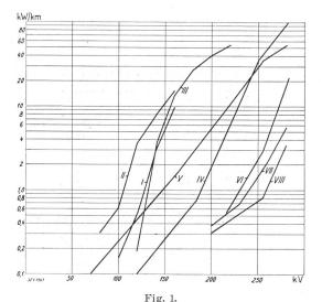
Koronaverlustmessungen an Dreiphasen-Freileitungen. luste in kW/km Leitungslänge in Funktion der verketteten Betriebsspannung.
