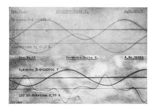
150 kV Freileitung Innertkirchen-Mühleberg. Sternpunkt in Innertkirchen über Stromwandler geerdet. Oben: 1 mm = 22,2 kV, resp. 8,2 A Unten; 1 mm = 35 kV, resp. 1,02 A Analyse des Erdstromes bei 103.8 kV Phasenspannung. Grundwelle  $100^{\circ}/_{0}$  3. Harmonische  $30,6^{\circ}/_{0}$  7. Harmonische  $3,4^{\circ}/_{0}$  5. Harmonische  $3,5^{\circ}/_{0}$  9. Harmonische  $6,6^{\circ}/_{0}$
