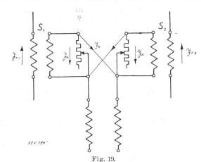
Parallellaufreglerschaltung für Induktionsregler.
