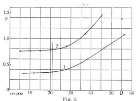
$\begin{array}{c} \mbox{Verlauf der dielektrischen Verluste} \ (p) \ \mbox{in Abhängigkeit [der Spannung} \ (U) \ \mbox{der 36000-V-Generatorwicklung} \ (B \ B \ C) \\ 1 = \mbox{Maschine kalt.} \quad 2 = \mbox{Maschine warm.} \\ \end{array}$
