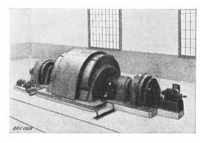
Fig. 16. Asynchron-Phasenschieber 21 500 kVA. (A E G).
