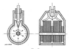
Fig. 27. Schema des Deïon-Schalters.
