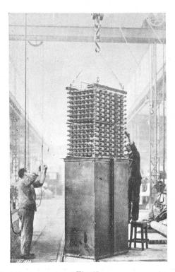
Fig. 15. Drehstromkondensator für 250 B kVA, 2000 V, 50 p/s. (Häfely, Basel.)
