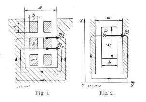
Wir wollen die Ueberlegungen für den  $p^{\rm ten}$  Stab machen. Wir legen ein Achsensystem [Fig. 2], so dass oz parallel zum Stab wird. Dann werden offenbar die 3 Komponenten des Vektors j im Punkte P
