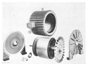
Fig. 14. Drehstrommotor mit Rippengehäuse. (M F O).
