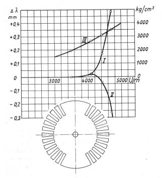
Fig. 1. Dehnungsmessung an rotierender Scheibe von 920 mm Durch-Dennungsmessung an rotterender Scheibe von 920 mm Durch-messer.
