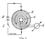
Elektromagnetische Prüfung Induktorkörpern auf Schmiede-fehler.
