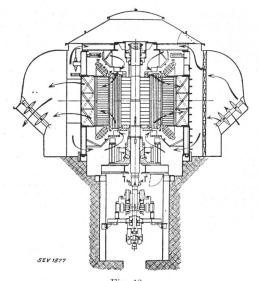
Fig. 12. Freiluft-Synchron-Phasenschieber für vertikale Aufstellung. (G E C).
