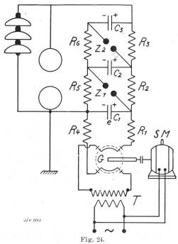
Stossprüfanlage für sehr hohe Spannungen.
