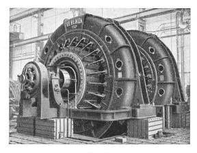
Fig. 13. Gleichstromgenerator für 6000 kW. (MFO).
