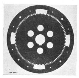
Fig. 11. [[ Rotor- und Statorblechschnitt einer Maschine für 8000 p/s. (Lorenz A.-G., Berlin.)
