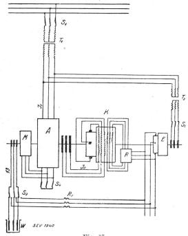
Fig. 17. Schaltungsschema für den Phasenschieber Fig. 16.
