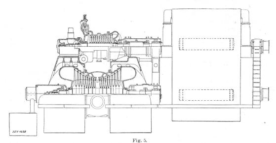
Doppelaggregat von Turbogeneratoren, 110 000 kW, jedes Aggregat macht 1800 U/m. (GEC).
