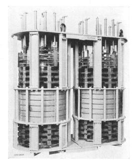
Fig. 18. Doppelinduktionsregler. (M F O).
