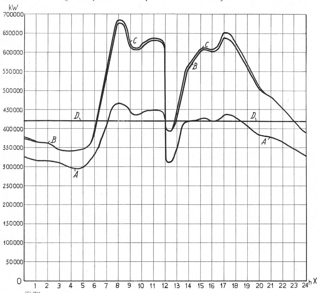
Leistung der Flusskraftwerke . . . . .  $\equiv OX \div A \equiv$  Puissance utilisée dans les usines au fil de l'eau.
