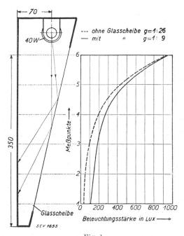
Fig. 1. Erhöhung der Beleuchtungsgleichmässigkeit bei angeleuchteten Schildern durch Anbringen einer zur Schildfläche geneigten Glasscheibe.
