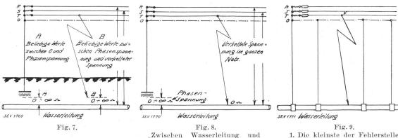
Zwischen Wasserleitung und Erdplatte tritt durch den Erd-schluss eine Schritt- oder Be-rührungsspannung entsprechend der Phasenspannung auf.
