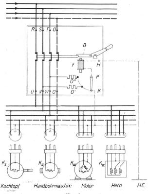
Fig. 1. Prinzip der Schutzschaltung.
