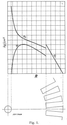
Verlauf der Beanspruchung in einem gebohrten Rotorkörper in Funktion des Radius.
