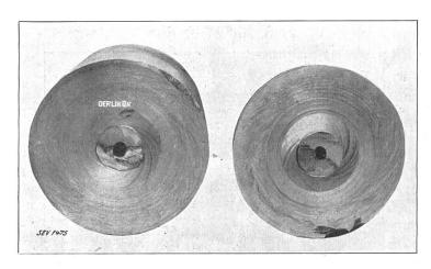
Rotorkörper mit gefährlichem Diametralriss. Fig. 7.
