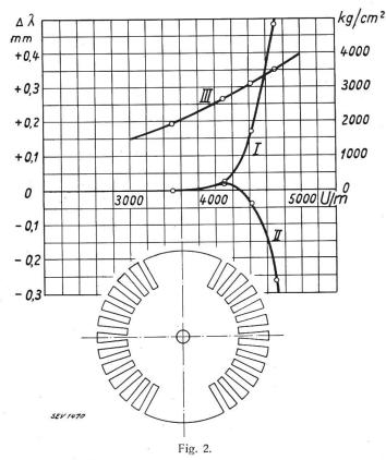
Scheibe von 920 mm Durchmesser. Dehnungen und Spannungen in Funktion der Umdrehungszahl pro Minute.
