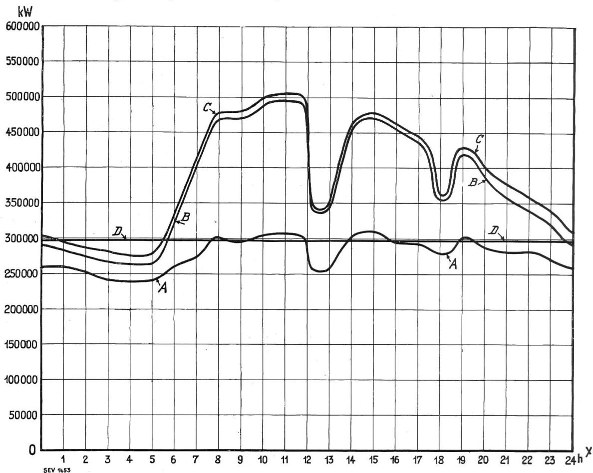
Leistung der Flusskraftwerke . . . . . =  $OX \div A$  = Puissance utilisée dans les usines au fil de l'eau.
