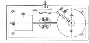
Fig. 9. Apparat für die Durchführung der Prüfungen der Nichterweichbarkeit und Feuersicherheit (§ 40).
