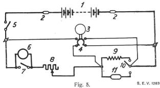
Schaltungsschema für die Prüfung der Kurzschlussicherheit.
