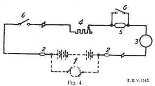
Schaltungsschema für die Prüfung der Ueberlastbarkeit.
