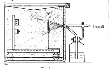
Fig. 6. Abschlusskasten und Zerstäuber für die Prüfung der Feuchtigkeitsbeständigkeit.
