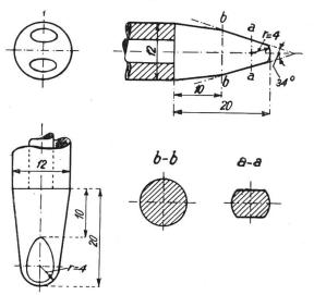
S. E. V. 1284 Fig. 7. Tastfinger für die Prüfung der Berührbarkeit spannungsführender Teile. Masse in mm.
