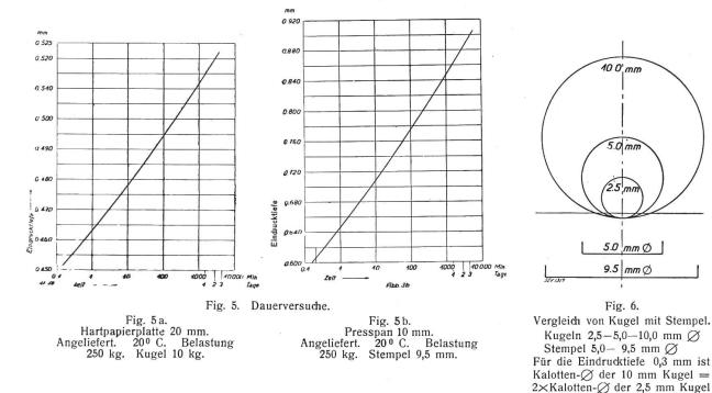
*Prüfdauer:* Aus den verschiedenen im weiteren Zusammenhange noch erwähnten graphischen Darstellungen und unter Berücksichtigung der unter den Vorproben bereits erwähnten Formel  $y = a \cdot \log x + b$  ergibt sich die Forderung für die Dauer
