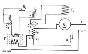
Fig. 1. Schéma d'excitation de génératrices à courant continu à haute tension, système Thury.
