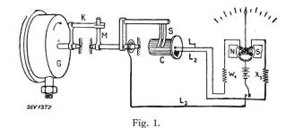
Fernübertragung von Hartmann & Braun mit Schleifkontakt am Geber und Kreuzspulinstrument als Empfänger.
