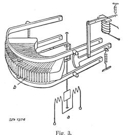
Doppelfallbügelgerät des Siemens Fernmesswerkes
