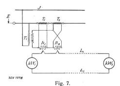
Schema der Fernübertragung mit Thermumformer nach dem Verfahren von Fawsett und der Cambridge Instrument Co.
