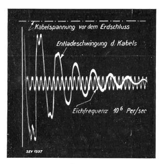
Fig. 27. Entladeschwingung beim Erdschluss eines einpoligen Kabels.
