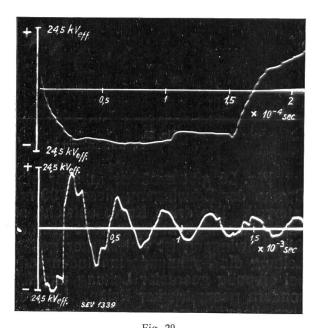
Entladeschwingung beim Erdschluss einer 45 kV-Leitung, gemessen auf der Leistungsseite (Fig. 28), bzw. Sammelschienenseite (Fig. 29) der Leitungsstromwandler und "Schutzdrosselspulen".
