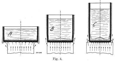
Schematische Darstellung der Wärmeströmung bei nicht übereinstimmendem Platten- und Topfdurchmesser.
