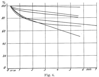
Verlauf des Widerstandes mit der Zeit, bei konstanter Spannung. Anfangswiderstand = 100 %.
