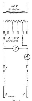
Fig. 1. Schema derVersuchseinrichtung. Bananenstecker II Messingelektroden A Ampèremeter V Voltmeter
