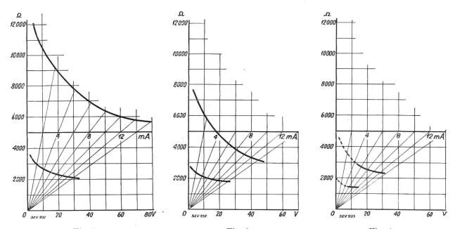
Fig. 3. Verlauf des Widerstandes in Abhängigkeit der Spannung bei gleicher Berührungsart. Stromdurchgang Hand-Hand. Zwei Elektroden von 20 mm Durchmesser fest umfasst.
