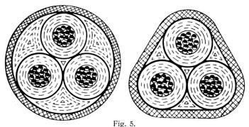
H-Kabel in runder und in SO-Bauart.
