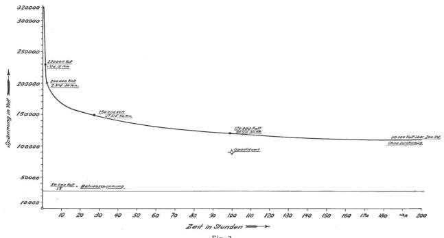
Fig. 3. Zeit-Durchschlagskurve, aufgenommen am Kabel der Fig. 2.
