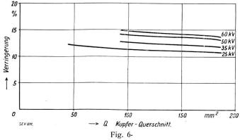
Gewichtsverminderung an unarmierten (keine Eisenarmierung) H-Kabeln bei Anwendung des SO-Prinzipes.
