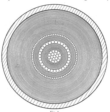
Fig. 4. Kabelquerschnitt System Silbermann.  $1\times100~\text{mm}^2$ ; Betriebsspannung 132 kV.
