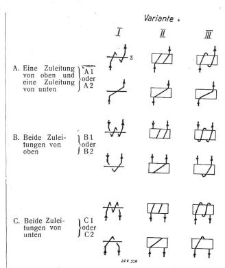
erste Variante Magnetkern durch Strich angedeutet. Zweite und dritte Variante mit Rechteck für Magnetkern.)
