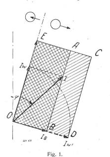
Die Maschine gibt Wirkleistung und Blindleistung ab (beide Rechtecke liegen rechts vom Spannungsvektor *OE*), verhält sich somit wie ein gewöhnlicher Synchrongenerator.
