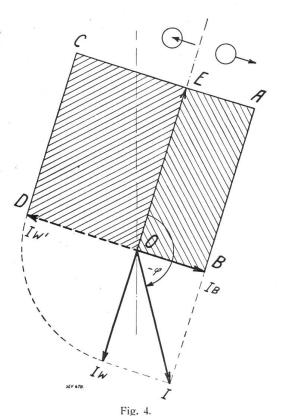
Die Maschine nimmt Wirkleistung auf (Rechteck links von OE) und gibt Blindleistung ab (Rechteck rechts von OE), verhält sich somit wie ein übererregter Synchronmotor (Phasenschieber).
