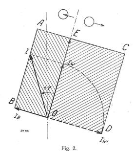
Die Maschine gibt Wirkleistung ab (Rechteck rechts von OE) und nimmt Blindleistung auf (Rechteck links von OE), verhält sich somit wie ein Synchrongenerator, der einen Kondensator speist, oder wie ein Asynchrongenerator.
