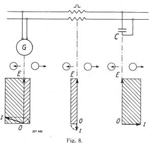
Speisung einer leerlaufenden Fernleitung mit grosser Kapazität. Ist die dem Generator aus der Kapazität zufliessende Blindleistung grösser als für die Erregung auf die normale Spannung erforderlich ist, so tritt Spannungserhöhung ein.
