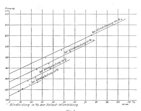
Fig. 6. Grösse der erforderlichen Erregung in Abhängigkeit der Blindleistungsabgabe neben einer konstanten Wirkbelastung.  $100^{\,0}/_0$  Erregung entspricht der Erregung bei Leerlauf und voller Spannung.
