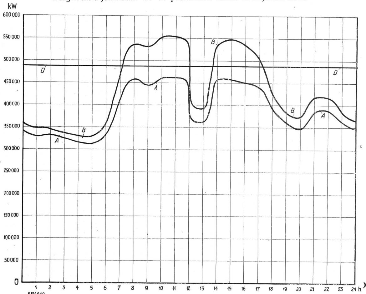
Leistung der Flusskraftwerke . . . . . =  $O \times D$  = Puissance utilisée dans les usines au fil de l'eau.
