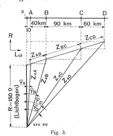
Einfluss des Lichtbogenwiderstandes auf Impedanz und Phasenverschiebung einer 110 kV-Leitung bei zweipoligem Kurzschluss. (Impedanz der Leitung: Z=1  $\Omega_c$ km Schleife;  $\cos\varphi=0,3$ .)
