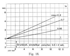
Brown, Boveri-Distanzrelais. Auslösezeit in Abhängigkeit der Impedanz bei cos φ der Kurzschlusschleife = 0,3:1 (Reaktanzrelais).
