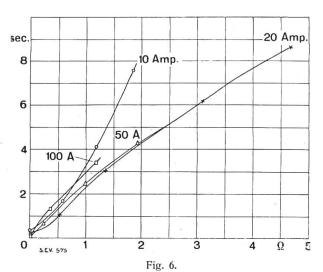
Westinghouse-Impedanzrelais. Auslösezeit in Abhängigkeit der Impedanz bei Strömen von 10--100 A.
