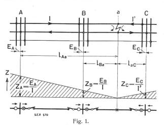
Verlauf der Leitungsimpedanz bei zweipoligem Kurzschluss. Prinzipielle Anordnung der Schutzrelais.
