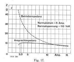
Brown, Boveri-Distanzrelais. Impedanz in Abhängigkeit des Stromes für das Ansprechen des Relais (Normalrelais).
