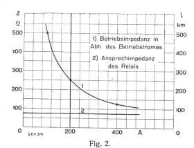
Vergleich der Impedanzen eines 50 kV-Netzes bei Normalbetrieb und im Störungsfall.
