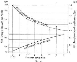
Fig. 4. Mittlerer Kochstromverbrauch pro Monat und pro Person/Tag von 647 Haushaltungen. (Elektr. Heisswasserspeicher vorhanden.)
