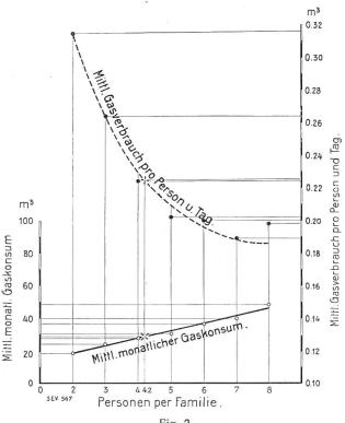
Fig. 2. Mittlerer Kochgasverbrauch pro Monat und pro Person/Tag von 436 Haushaltungen (elektrischer Heisswasserspeicher vorhanden.)
