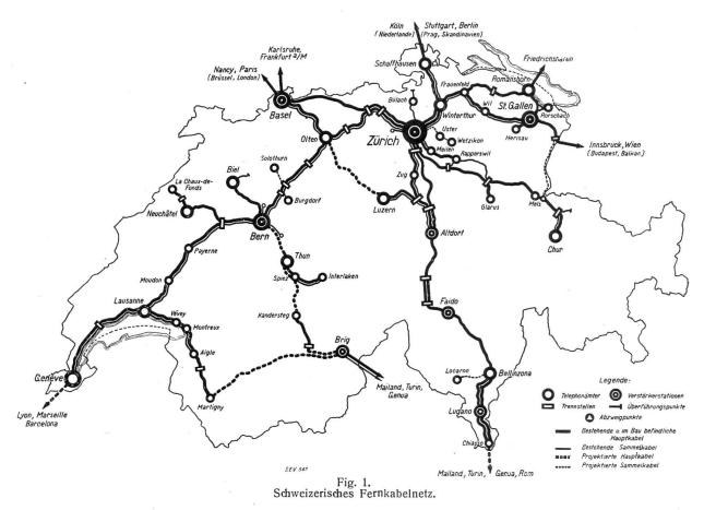
haupt nicht mehr betrieben werden können. Dass man sich bei diesem Anlass für die Auslegung von Fernkabeln entschied, ist nach dem Gesagten wohl selbstverständlich. So entstand denn binnen wenigen Jahren das in Fig. 1 dargestellte Kabelnetz.
